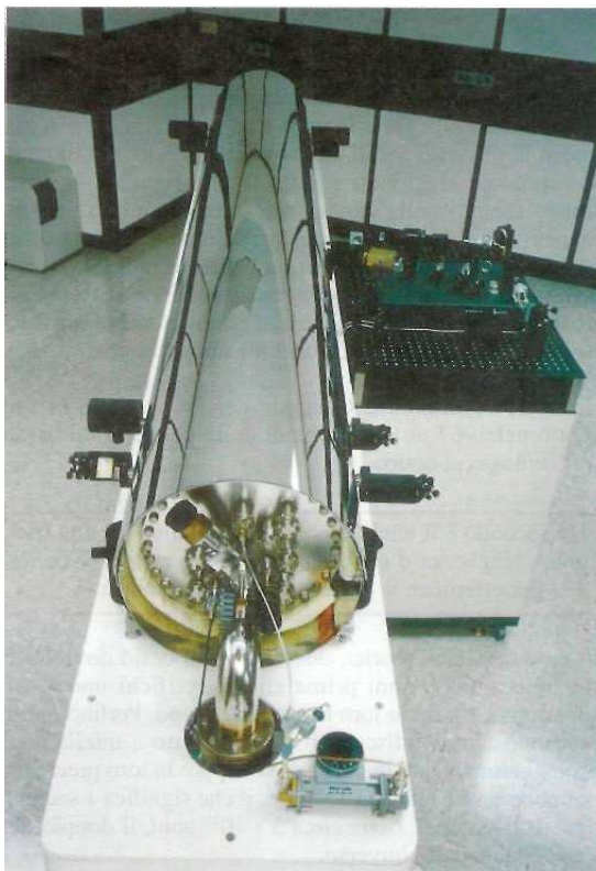
Figura 2.1: Il campione di unità di misura del tempo basato sulla frequenza atomica del cesio al NIST. È il campione primario per la misura del tempo negli Stati Uniti. Si può chiamare il numero telefonico ++1(303)4997111 per regolare il proprio orologio.
