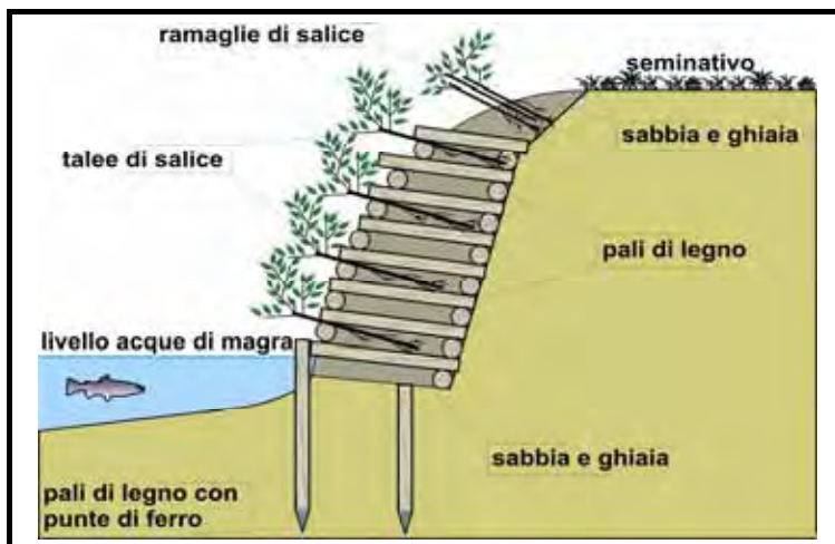
Fig. 1.61 - Esempio di intervento di difesa sponale con le tecniche dell'ingegneria naturalistica.
