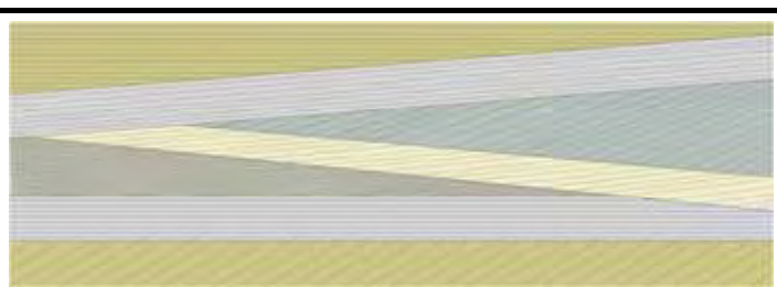
Fig. 1.15 - La stratificazione incrociata è una struttura fisica di sedimentazione caratterizzata da lamine di stratificazione di deposito deltizio con diversa inclinazione a causa del mutare del regime idrologico del fiume e del livello marino. Tale struttura fisica è caratteristica anche delle facies eoliche.
