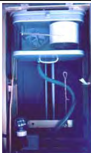
Fig. 1.37 - A sinistra una capannina meteorologica con strumenti per la misura dei parametri atmosferici ad altezza d'uomo ed un pluviometro a forma di cilindro sormontato dall'imbuto che raccoglie l'acqua delle piogge (vedi anche fig. 1.11 ). A destra si osservano i meccanismi interni del pluviometro, che consentono la rilevazione continua della quantità di precipitazione.
