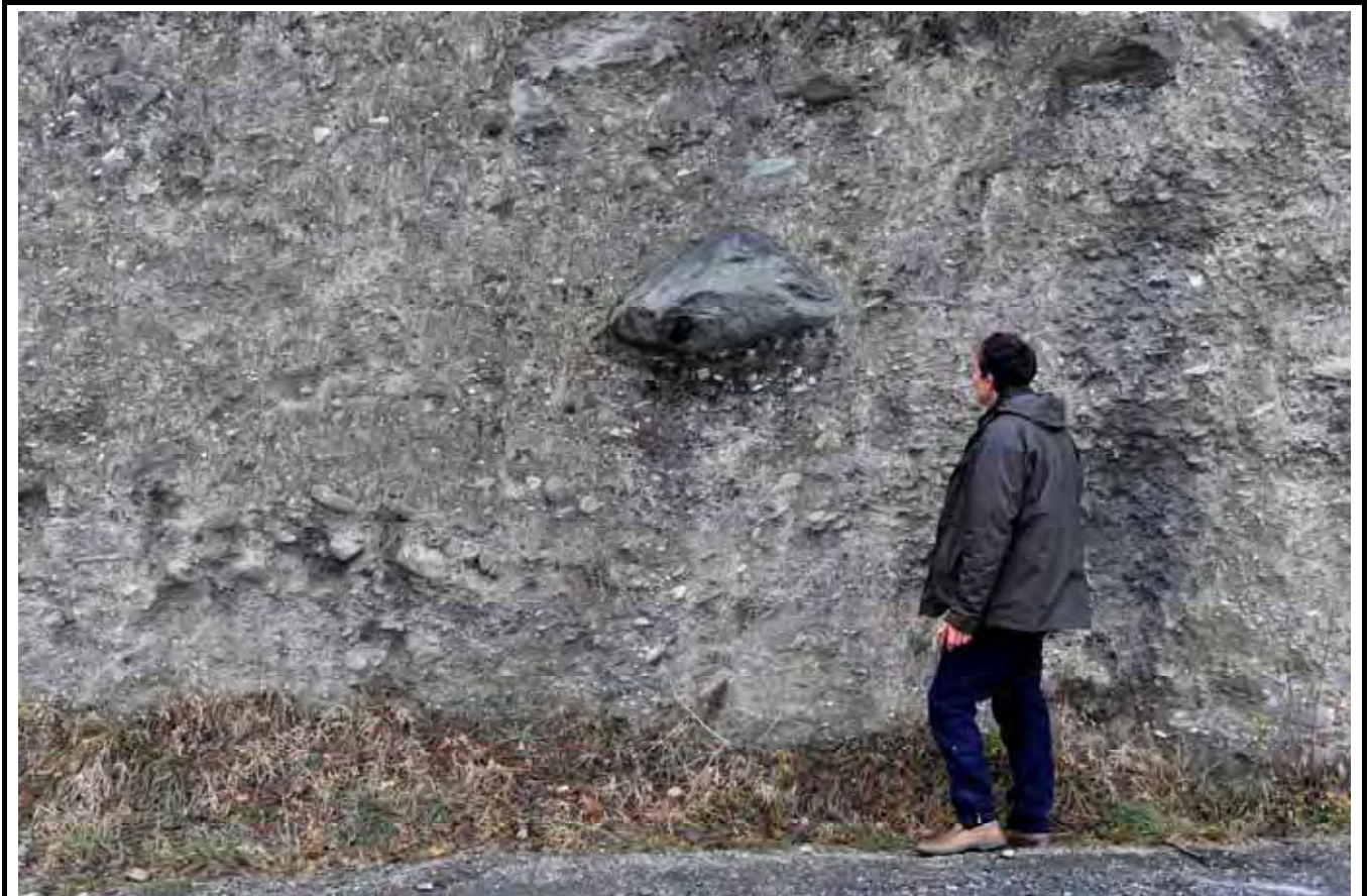
Fig. 2.27 - Lungo una strada, la cui costruzione ha comportato il taglio di un versante sul quale è depositata una morena, è possibile osservare, in dettaglio, la composizione granulometrica del materiale depositato da un antico ghiacciaio. Un masso di dimensioni metriche si trova insieme a clasti delle dimensioni della ghiaia e ad altri materiali decisamente più fini (sabbia e limo).
