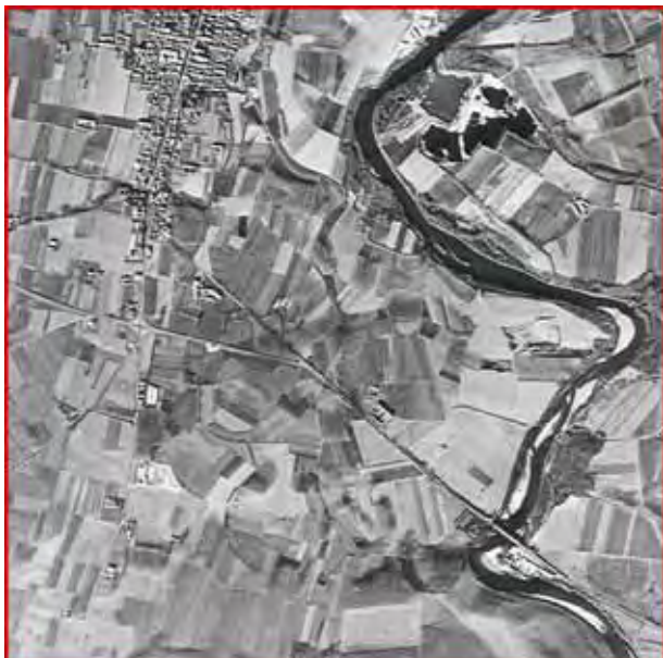
Fig. 3.17 - In questa foto aerea si osserva, in alto a sinistra, un centro abitato attraversato da una strada principale che, a Sud del paese, prosegue attraversando il fiume (in basso a destra). In centro a sinistra vi è un incrocio con una strada che giunge da Ovest che evita così l'attraversamento del paese. Da sud verso Nord il fiume scorre formando ampi meandri.
