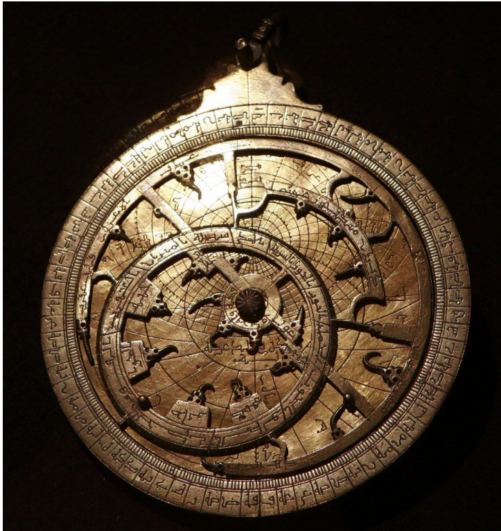
Figura 3.6 | Astrolabio, Marocco, XVI secolo. (Parigi, Museo Navale). L'astrolabio è un dispositivo estremamente versatile che consente vari impieghi ed assolve a diverse funzioni astronomiche e geodetiche. Apparve in Occidente prima del 1025. (Wikimedia Commons; user Rama)
